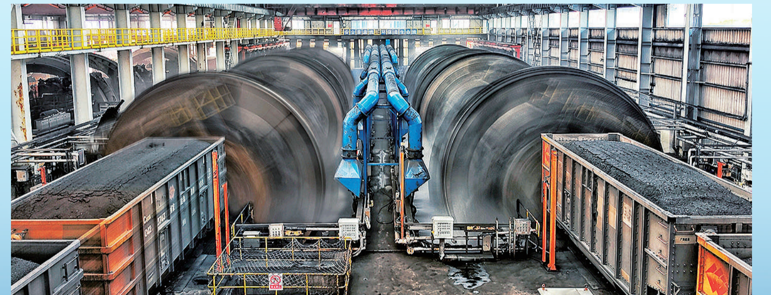
黄骅港创新自主研发长效抑尘系统,在卸煤过程中进行分洒洒水,通过振动给料使水与煤炭均匀混合,实现粉尘颗粒的有效附着,从源头抑制煤尘产生。该技术获得3项国家专利,荣获第45届日内瓦国际发明博览会金奖。图为港口公司黄骅港务翻车机正在卸卸煤炭。
