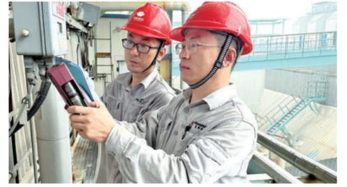
10月28日，电科院《W火焰锅炉安全低碳优质全燃煤煤关键技术及工程应用》《灵活运行方式下燃煤发电机组安全性经济性提升关键技术研究及应用》分获2024年电力行业创新创意大赛一、二等奖，两项成果在聊城等10余家发电企业成功应用。图为试验人员测量脱硝出口二氧化硫浓度。通讯员 陈辉 王睿 葛荣 摄
