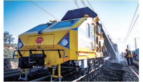
10月25日，由铁路装备与中国铁建高新装备公司联合研发的国内首台完全自主知识产权的组合挖掘模式CQS-350型道岔清筛车在新朔铁路大准线秋季集中修投入使用。图为该车进行道岔机械清筛作业现场。通讯员 边进 摄
