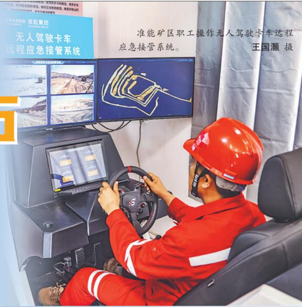
准能矿区职工操作无人驾驶卡车远程应急接管系统。 王国源 摄
