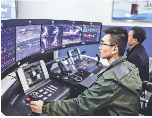
神东煤炭榆家梁煤矿员工通过智能集控室进行工作面远程干预割煤。 通讯员 吴光丽 摄
