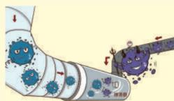
瓦斯气是煤矿开采过程中释放出的有害气体，主要成分是甲烷；乏风被称为“煤矿风排瓦斯”，其甲烷浓度极低。这对“废气兄弟”渴望在清洁环保与能源再利用的舞台上展现自己的价值，由此开启瓦斯氧化蓄热旅程，乘坐瓦斯输送管道来到第一站——掺混器。
