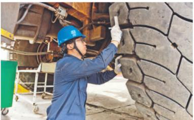
▲6月18日，胜利能源设备维修中心启动专项点检行动，将修补维护与点检排查深度融合，为迎峰度夏提供坚实有力设备支撑。图为轮胎工在测量轮胎花纹沟深。通讯员 莫日更 摄
