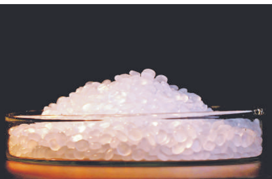
▲ 包头化工聚乙烯产品DFDA-7042为线性低密度挤出薄膜料，具有拉伸强度高、耐低温性和耐高温性强、不易断丝及抗环境应力开裂等优点，广泛应用于农膜、衬垫、地膜、薄膜等领域。 通讯员 葛珂宁 摄
