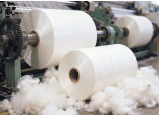
▲ 新疆化工68万吨/年煤基新材料项目以煤为原料，年产180万吨甲醇，进一步加工成聚烯烃产品。该公司持续推动产品多元化发展，煤基新材料成功应用于汽车、农业、医疗及食品包装等领域。其中，2025年首次研发的聚丙烯产品GX2026S是一种中等流动纤维级的聚丙烯产品，具有优异的刚韧平衡和成纤拉丝性能。图为聚丙烯GX2026S产品。 通讯员 李瑞清 摄
