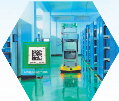
▲智能仓储AGV通过地面二维码精准识别路线。
