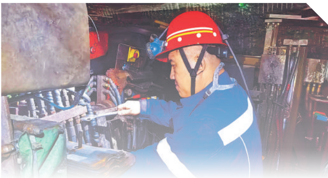
检修工在检修掘锚机钻臂液压阀组。
