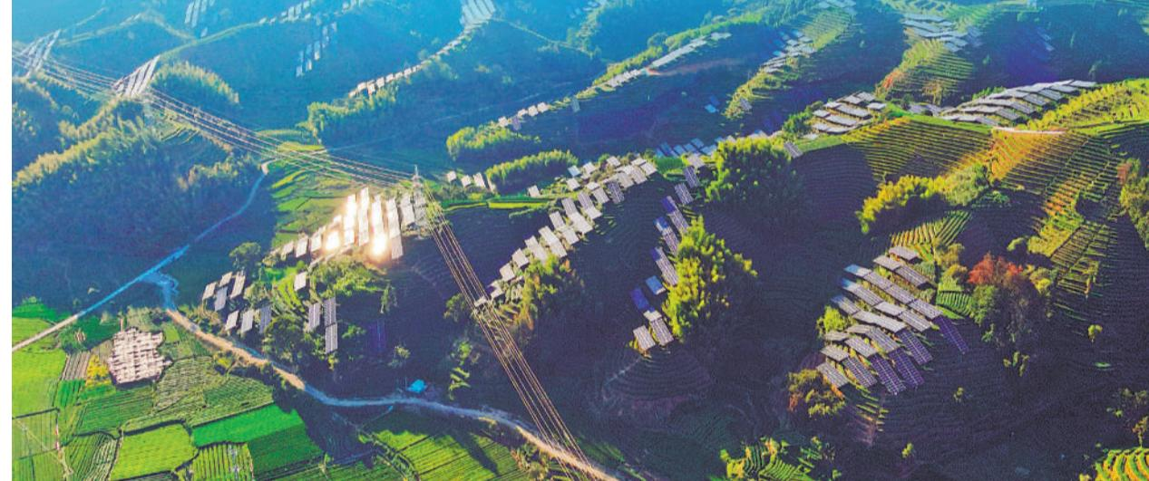
10月10日,国家能源集团浙江公司大柘光伏站03WBT01、03WBT02最后两台箱变冲击带电,标志着该公司遂昌一期95兆瓦茶光互补光伏发电项目顺利实现全容量并网。该项目是浙江公司在浙江省内部署的最大地面集中式光伏发电项目,占地面积约3000亩,交流侧装机容量95兆瓦,直流侧装机容量达123.5052兆瓦,共分为53个光伏发电单元,通过自建5回35千伏集电线路接入新建110千伏升压站。项目全容量投产后,预计年均可供绿电12654.3万千瓦时,相当于节约标准煤38659吨,减少二氧化碳排放103006.4吨。图为遂昌一期茶光互补光伏项目航拍图。
