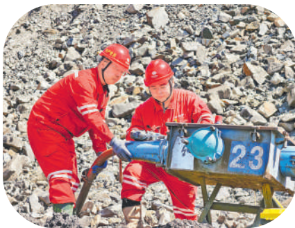
维修电工正在检查分线箱电缆快速接头密封情况。谢东磊摄
