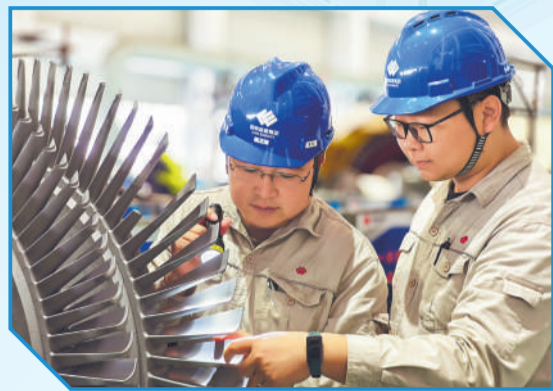
汽机检修人员在检查小机叶片。
