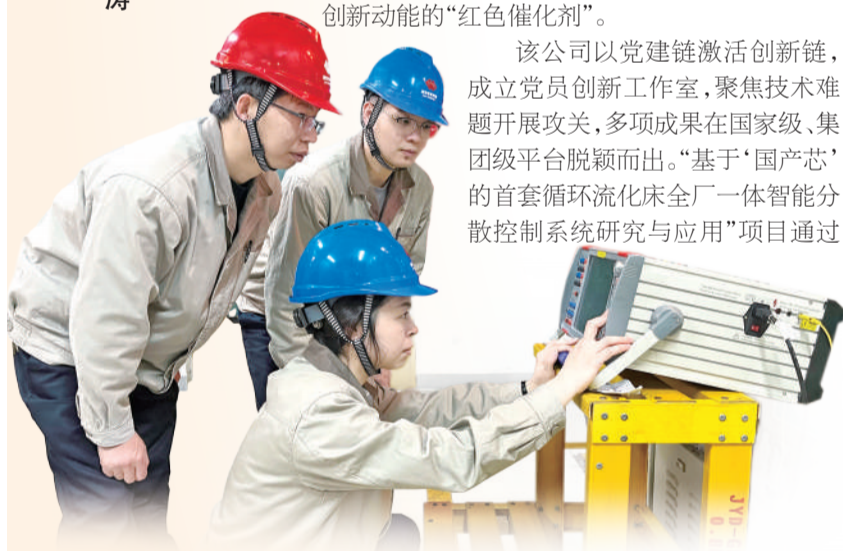
“党员先锋队”对保护装置进行校验检查。
