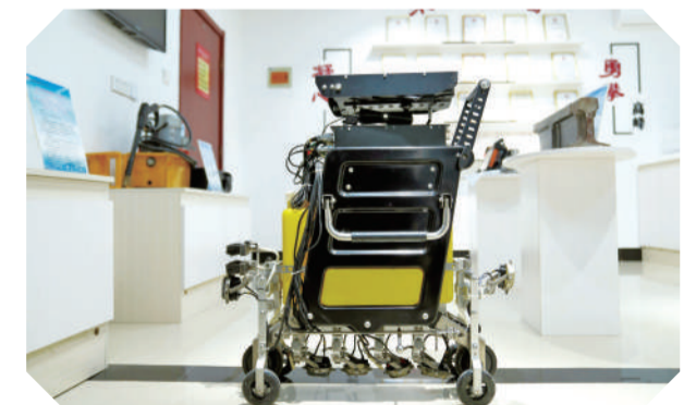
数字化智能钢轨焊缝一体探伤仪。
