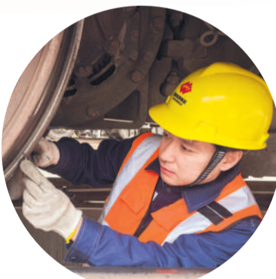
作业人员正在测量轮缘关键系数。
