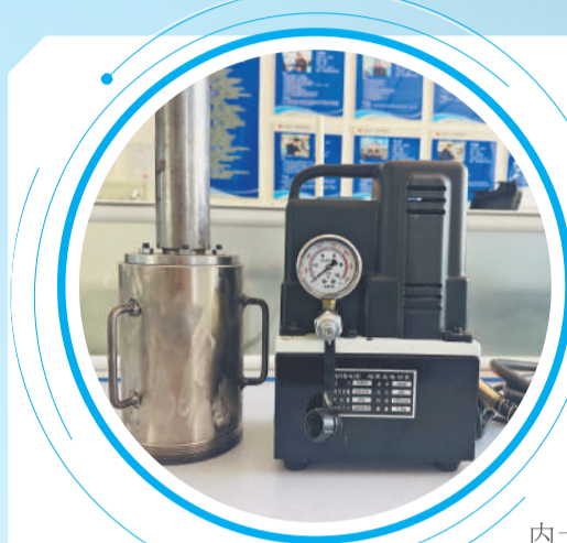
便携式牵引电机油封拔出装置。
