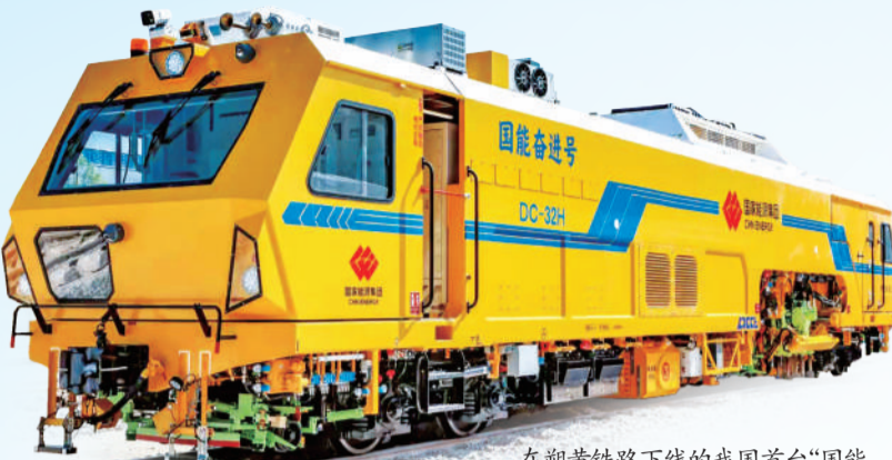
在朔黄铁路下线的我国首台“国能奋进号”铁路隧道双动力智能捣固车。
