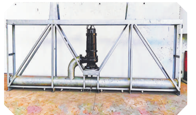
水下槽道清洗装置。
